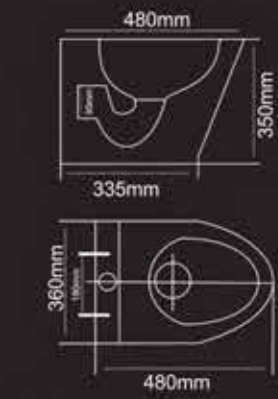
فاصله دو پیچ محل نصب روی فلاش تانک توکار (180 mm)
